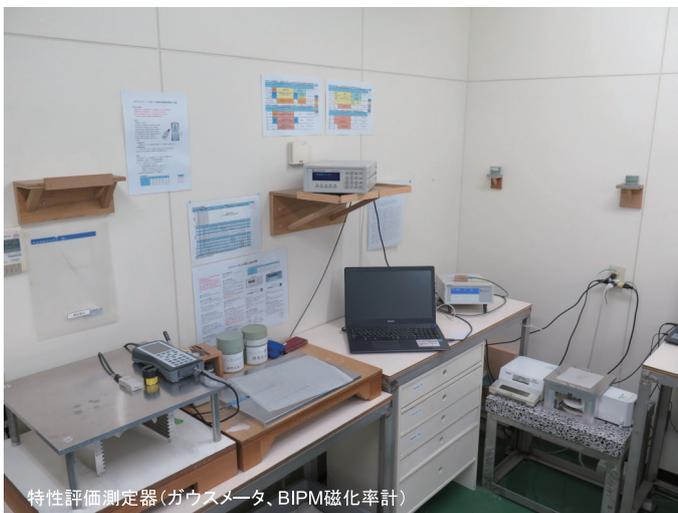
特性評価測定器(ガウスメータ、BIPM磁化率計)
