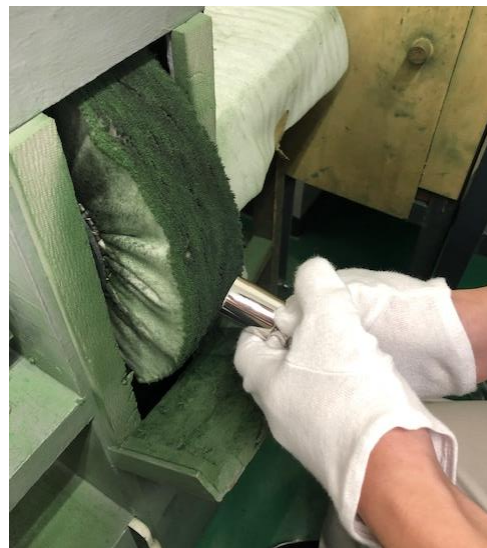
図5 調整孔の無い円筒型分銅の質量調整 (バフ研磨)
