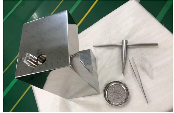
図4 まくら型分銅の質量調整 (調整材の加除)
