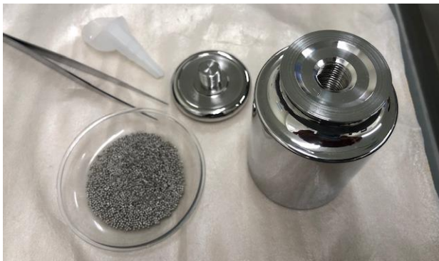
図3 調整孔を有する円筒型分銅の質量調整 (調整材の加除)
