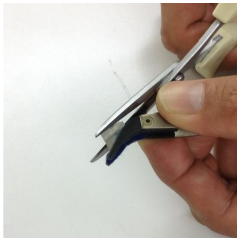
図6 板状分銅の質量調整 (ハサミ切断)
