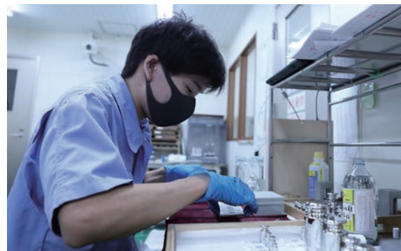
お客さまから校正依頼が来た分銅の受け入れ作業をする濱田さん。錆や傷を確認し、校正を行う。傷や薬品による錆は重さを変える要因になる。
