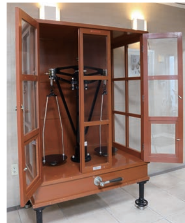
昭和2、30年代に作られていた等比基準天びん。当時は家具職人も社内にて、天びんを納めるケースも自社生産していた。最大20kgまで測定可能。
