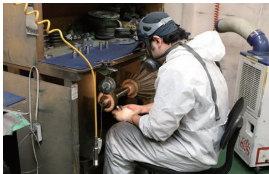
研磨室。微妙な質量の調整を行い、質量の誤差を限りなくゼロに近づける。
